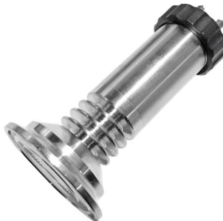
PCM1350 Санитарный датчик давления с открытой мембраной применяется в пищевой, фармацевтической и биологической технике. Цельнометаллическая заподлицо изолирующая диафрагма скрытого монтажа с прямым присоединением к процессу, чтобы обеспечить точное соединение между присоединением к процессу и измерительной диафрагмой. Следовательно, никаких дополнительных уплотнительных прокладок не требуется, и это гарантирует отсутствие мертвых зон измерения.
